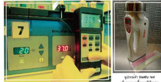
การตรวจสอบอุณหภูมิด้วย Digital Thermocouple เพื่อบันทึกอุณหภูมิประจำทุกวัน
